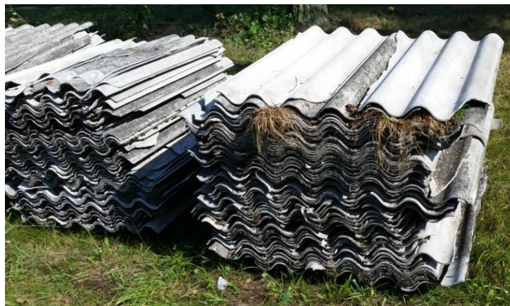
Rys. 2. Odpady zawierające azbest – zmagazynowane płyty faliste ( źródło: materiały własne ).
